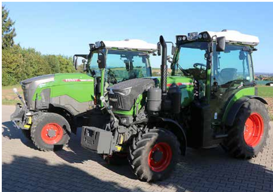
Dva ozkolotečna traktorja primerljivih zmogljivosti, a z različnim virom energije – elektrika (levo) in dizel gorivo (desno). Vsi sklopi, razen motornega, so identični.
