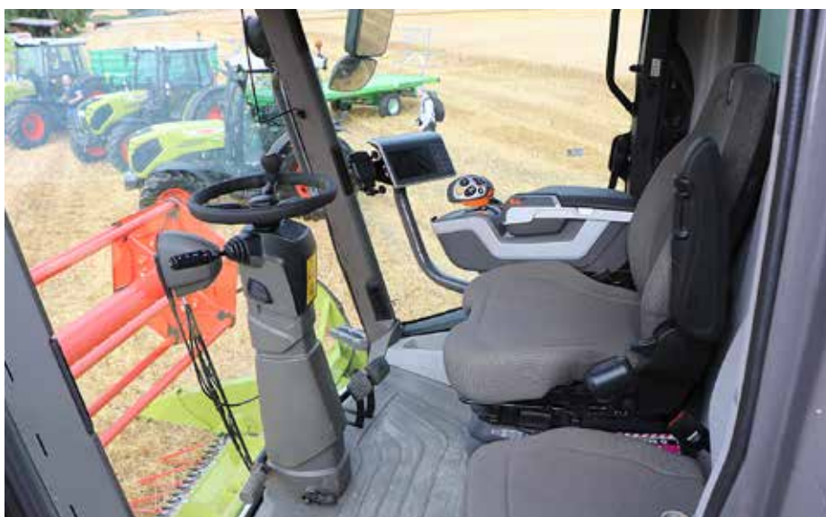
Moderna kabina postavlja merila v segmentu kombajnov, ki ga pokriva nova serija Evion. Vozniku sta med drugim na voljo CMotion večnamenska krmilna oziroma vozna ročica in terminal Cemis 700 s sedemcolskim zaslonom, občutljivim na dotik.
