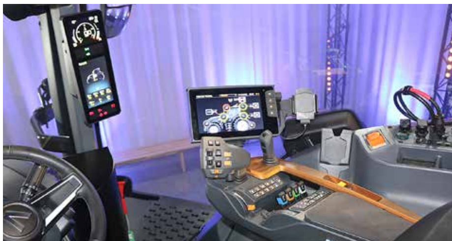
Za Valtro značilna in uporabnikom znana notranjost kabine. Na sliki desna krmilna konzola in prikazovalnik na levem A stebru kabine.
