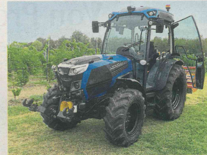
Der Rex4 120 GT Roboshift Dynamic ist ausgestattet mit dem Mitions-Joystick SmartPilot. Damit können das Getriebe, die Zapfwerschaltung, die Motordrehzahl und die Elektrohydraulik bedient werden.
