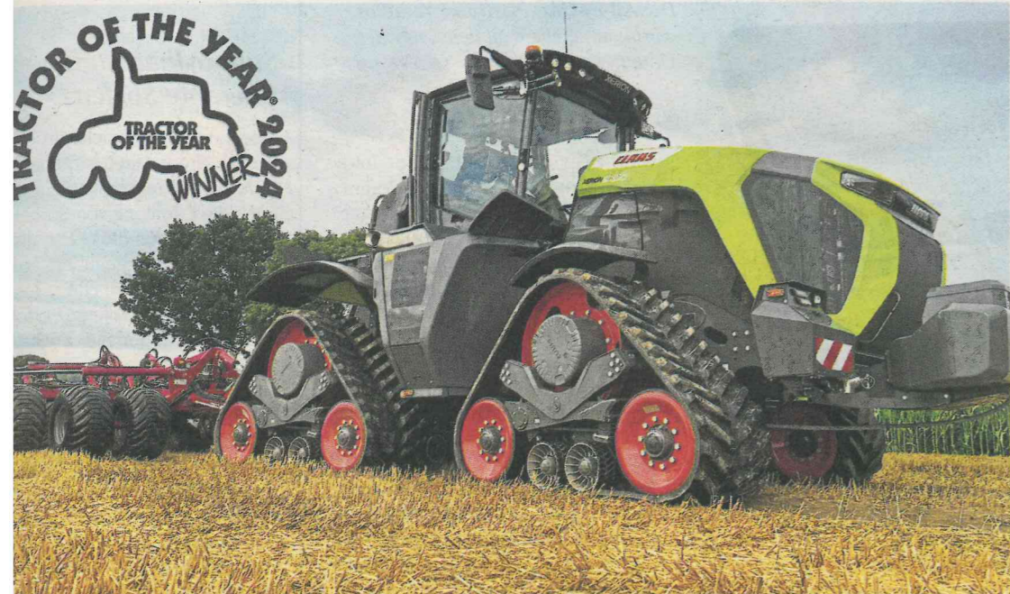
Der Xerion 12.650 Terra Trac ist mit seinen 636 PS der stärkste Traktor mit stufenlosem Getriebe.
