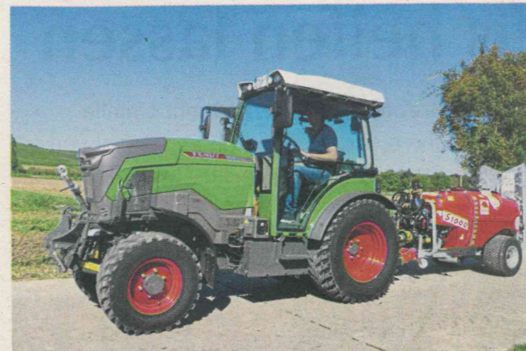
Der e107 V Vario ist mit einer CCS2-Steckdose ausgestattet, die das Laden mit Wechselstrom bis zu 22 kW ermöglicht. Er kann auch über eine 32-A-Kraftsteckdose geladen werden, wenn ein mobiles Ladegerät mit 22 kW verwendet wird.
